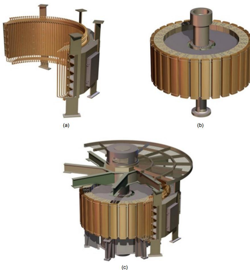
Figura 4.1 – (a) Estator completo: enrolamentos fixados no núcleo; (b) rotor completo; (c) Máquina completa: Estator + Rotor.
