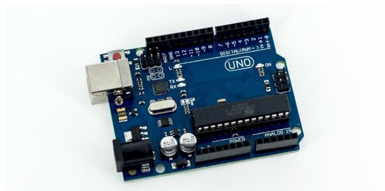
A Figura 3.3 Apresenta uma placa de Arduino UNO do mesmo modelo que foi utilizada no sistema.
