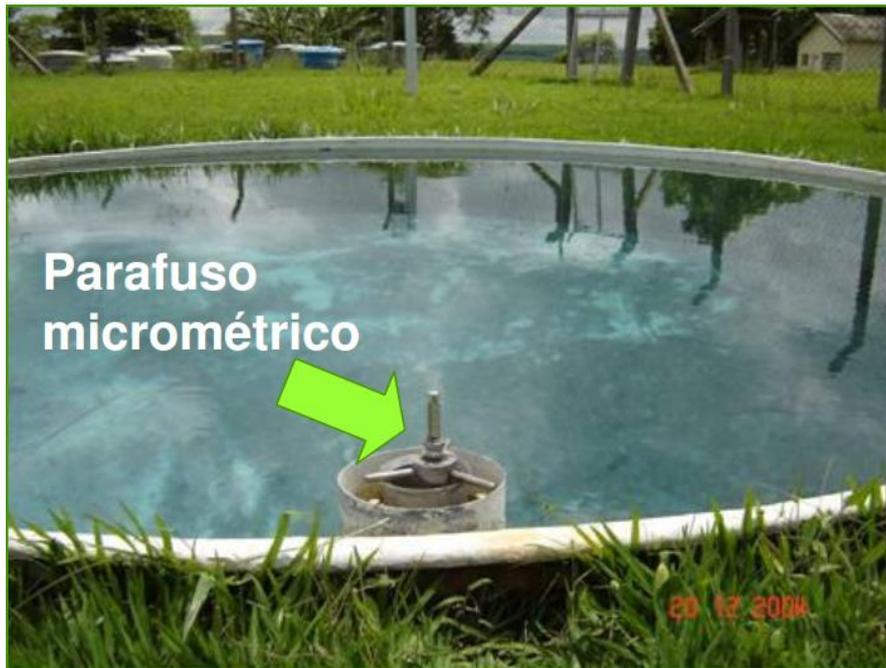
A Figura 2.6 Simboliza um tanque de 20 metros quadrados utilizado para medir a evaporação. Suas medidas são parecidas com às obtidas em lagos. Logo não há muita influência de fatores externos.
