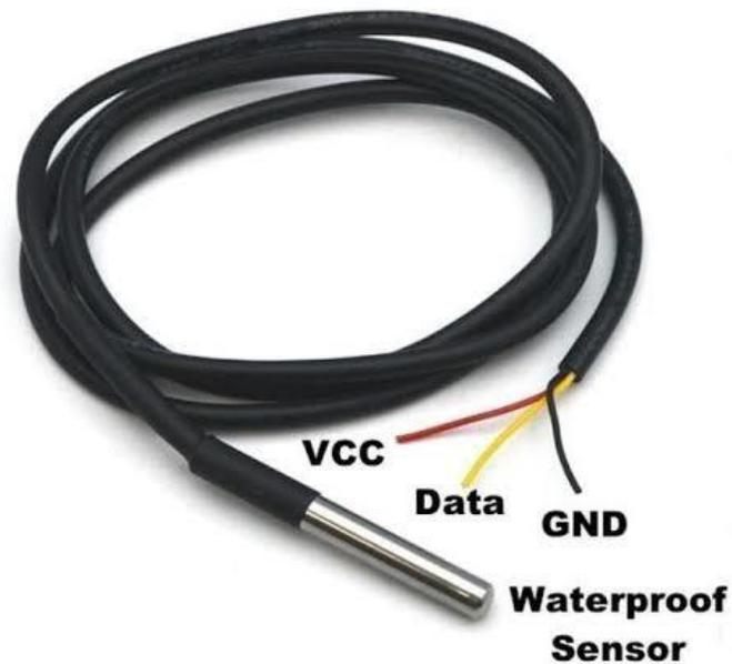
Figura 3.6 Sensor de Temperatura DS18B20 que foi usado no sistema para realizar a medição da temperatura ambiente. Um resistor de 4,7 KOhm foi ligado do fio de dados (fio amarelo) para o VCC. Esse resistor de Pull Up garante que a leitura do sensor no pino digital não irá ficar flutuando e se manterá estabilizada.
