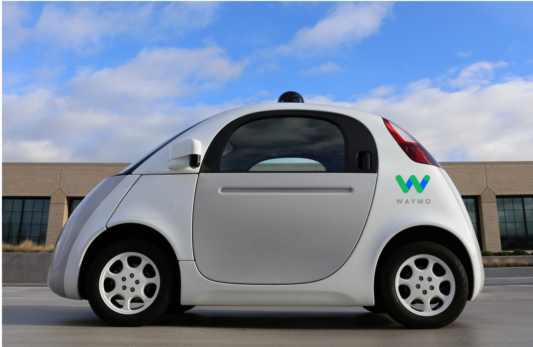
Figura 2.2: Um carro autônomo com sistema de LiDAR Fonte:Waymo
