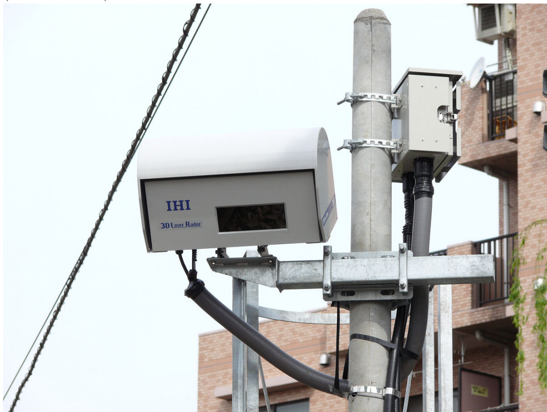
(b) Este LiDAR fixo é utilizado em um cruzamento em nível para detectar a presença de pessoas ou veículos na via do trem. Fonte: Yoji Isaka/Wikimedia Commons (CC-BY-2.1)
