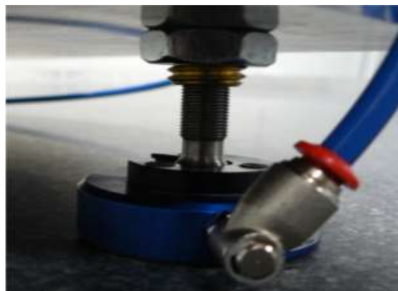
Figura 1. Esquemático e estrutura real responsável por expelir o ar pressurizado (Rybus, 2013)
