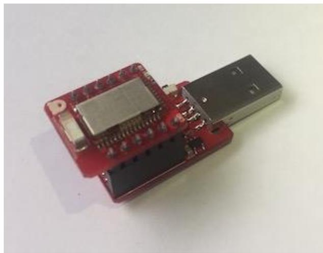
Figura 2.13 – RedBear BLE Nano 2 e DAplink Fonte: ("redbear/nRF5x", 2018)
