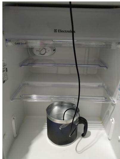
Figura 3.7: Leitura de temperatura na água. Recipiente Alumínio. *Posição 2.*
