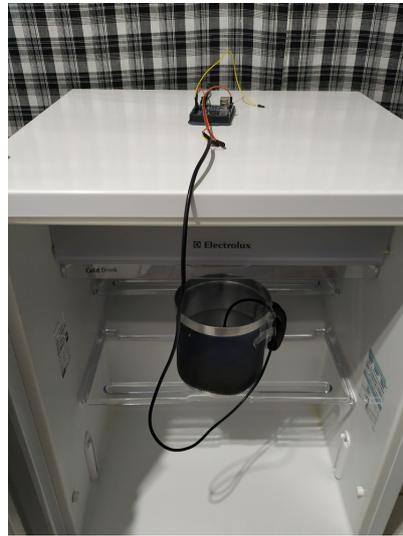
Figura 3.5: Leitura de temperatura na água. Recipiente Alumínio. *Posição 1*.
