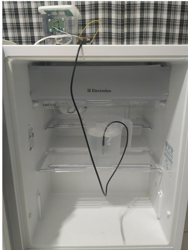
Figura 3.13: Resfriamento da água a 5°C. Controle liga/desliga. Recipiente de plástico.
