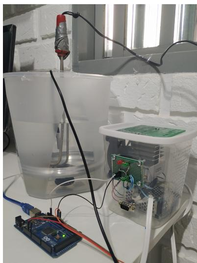
Figura 4.4: Sistema de controle de temperatura para aquecimento
