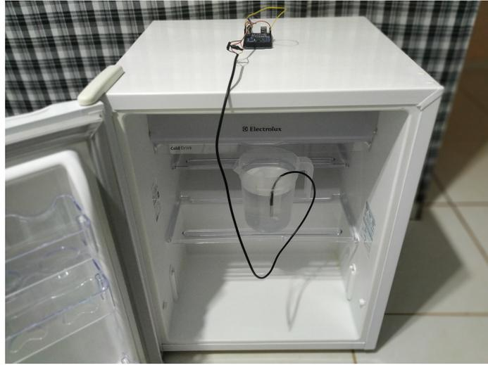
Figura 3.4: Leitura de temperatura na água. Recipiente Plástico. *Posição 1*.
