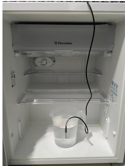
Figura 3.6: Leitura de temperatura na água. Recipiente Plástico. *Posição 2.*
