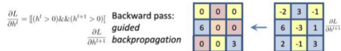
Figura 23 – Comportamento da técnica Guided Backpropagation lidando com a não linearidade do camada ReLU
