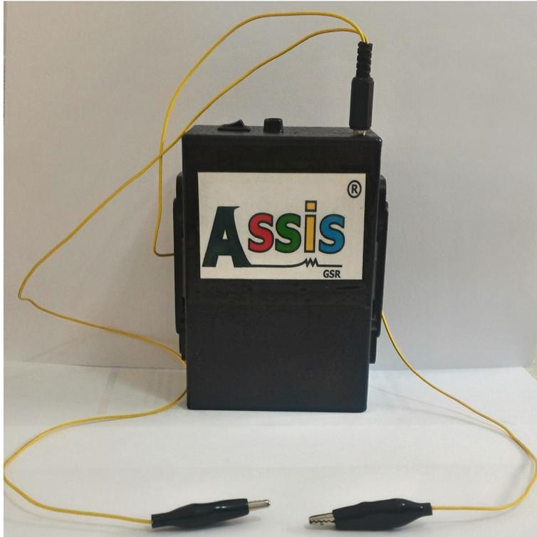
Figura 13 – Dispositivo Eletrônico que mede a Resistência da Pele - Assis.
