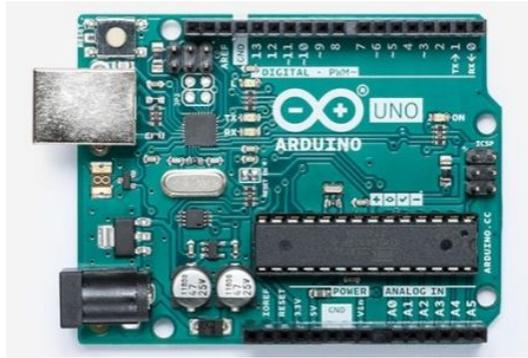
Figura 7 – Microcontrolador Arduino Uno
