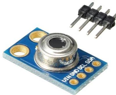
Figura 8 – Diagrama do sensor de temperatura Infravermelho.
