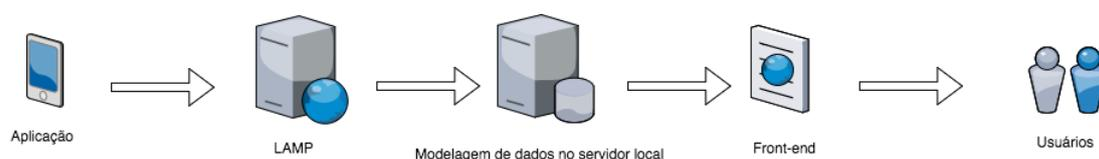
Figura 3.2: Arquitetura simplificada da ferramenta de BI&A. (Fonte: autor)
