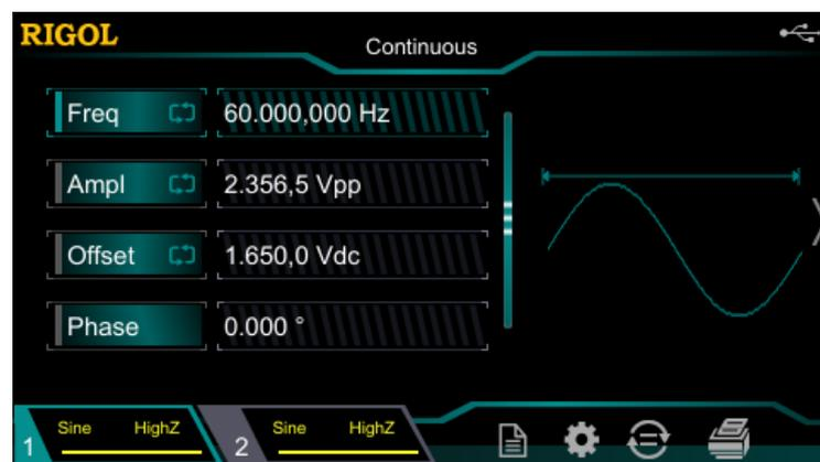
Figura 31 – Configuração de saída do gerador de funções (tensão).
