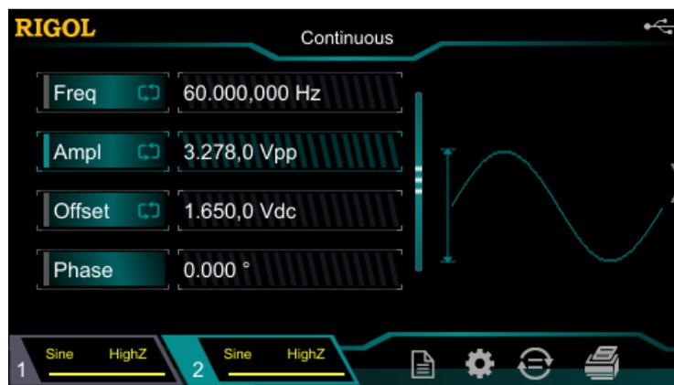
Figura 33 – Configuração de saída do gerador de funções (corrente).
