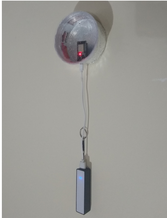
Figura 14 – Fotografia da ESP-32 com semiblindagem de alumínio e atuando como antena emissora.
