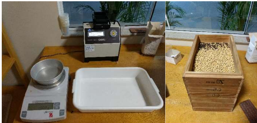
Figura 3. Balança, Medidor de Umidade e Peneiras.
