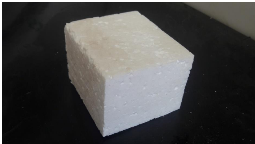
Figura 7 – Cubo em EPS confeccionado para a estimativa da densidade do material. Tamanho aproximado 10x9x7 centímetros.
