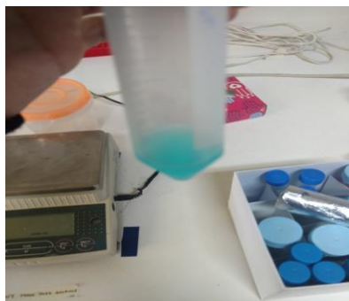
Figura 7 – Fotografia de Tubo de centrífuga contendo nanoemulsão de cloreto de alumínio ftalocianina fornecida e desenvolvida no Laboratório de Nanobiotecnologia da Universidade de Brasília - UnB.
