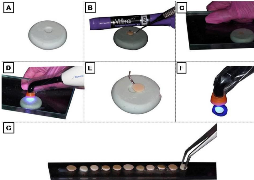
Figura 1. Sequência do preparo dos espécimes de resina. A: molde de silicone previamente preparado com dimensões 8mmx5mm e 1mm de espessura; B: resina Vittra APS (FGM, Joinville, Brasil) sendo ajustada ao molde; C: pressão com placa de vidro; D: fotopolimerização por 20s; E: remoção do espécime do molde; F: fotopolimerização fora do molde por mais 20s; G: fixação dos espécimes em régua.
