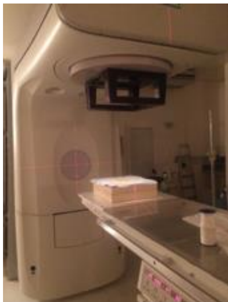
Figura 4 - Acelerador linear, modelo Primus (Siemens, Alemanha), utilizado para aplicação de radiação ionizante sobre as amostras dos respectivos grupos
