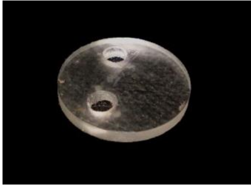
Figura 7 - Matriz em resina acrílica embutida, utilizada para confecção das amostras para o teste de alteração dimensional volumétrica
