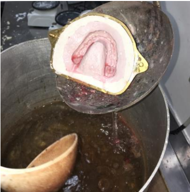
Figura 35: Remoção, com água quente, do remanescente de cera do molde de silicone.
