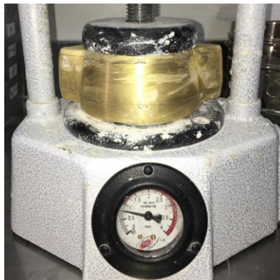
Figura 32: Mufla sendo submetida a 0.75 toneladas na prensa hidráulica para melhor coesão entre suas peças e o gesso.
