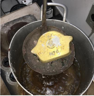
Figura 33: Mufla sendo imersa em água quente para facilitar a demoldagem e derretimento da cera.
