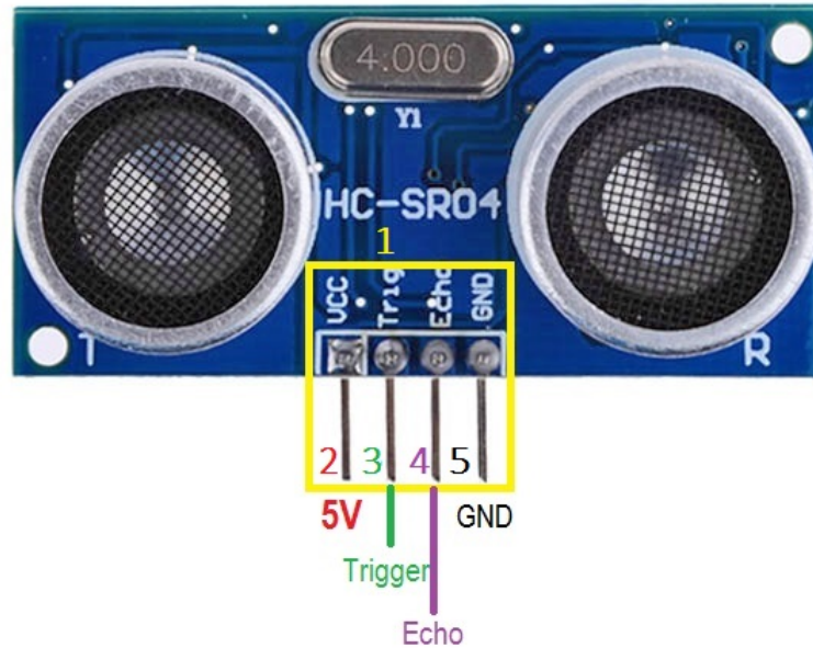
Figura 3.11: Módulo sensor ultrassônico HC-SR04 - Fonte: www.adrobotica.com [6].
