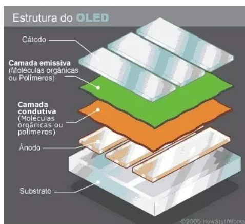
Figura 3.12: Estrutura das telas OLED - Fonte: https://www.arealocal.com.br/[7] .
