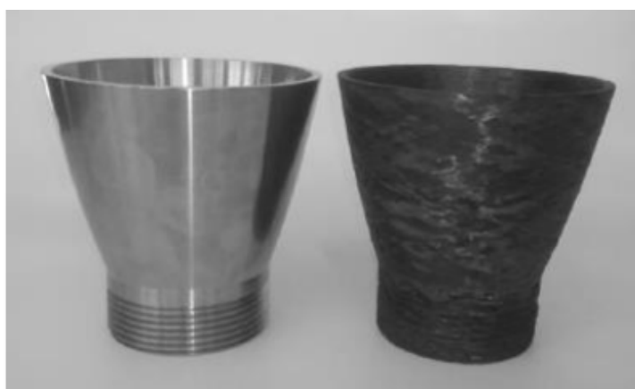
Figura 12 – Tubeira de Aço 304L e plástico reforçado com fibra de carbono de Andrianov, 2015. Fonte (Pessoa,2017).
