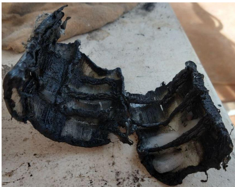
Figura 28: Grão híbrido deformado após o teste (DOMINGOS C. H. F. L., 2019)
