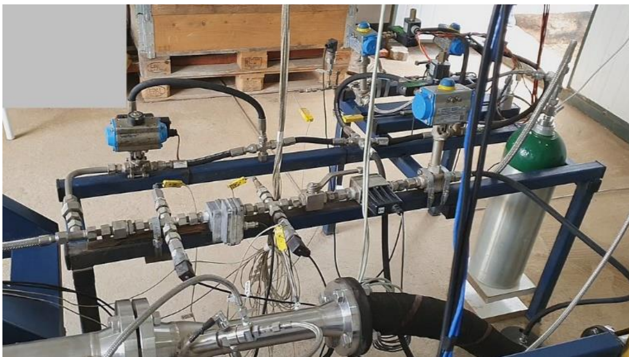
Figura 7: Sistema de alimentação e controle montado. Obtido em ( http://fga.unb.br/cpl )
