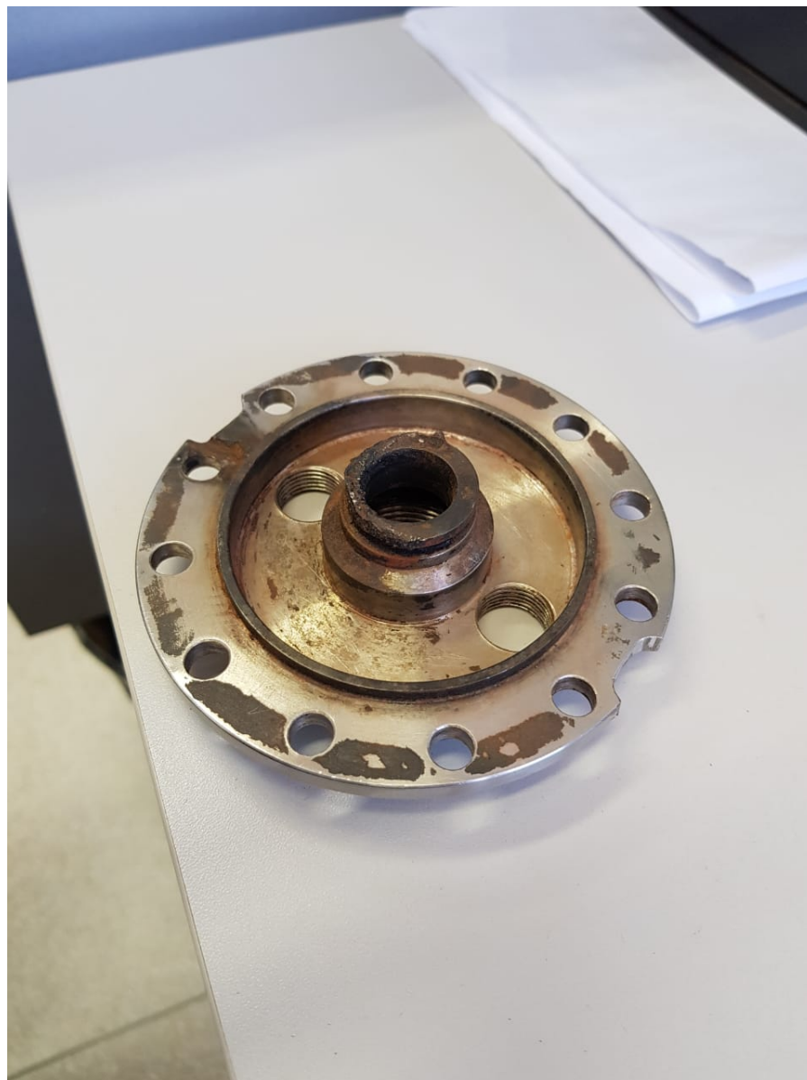
Figura 14 – Peça no qual o óxido nitroso será injetado para ser conduzido até o disco injetor
