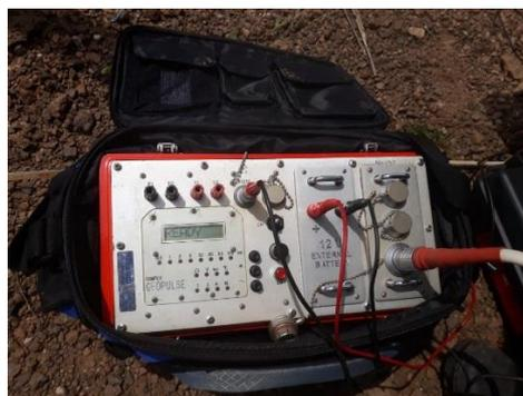
Figura 5.10 - Resistivímetro Geopulse usado para as medições de resistividade do solo.
