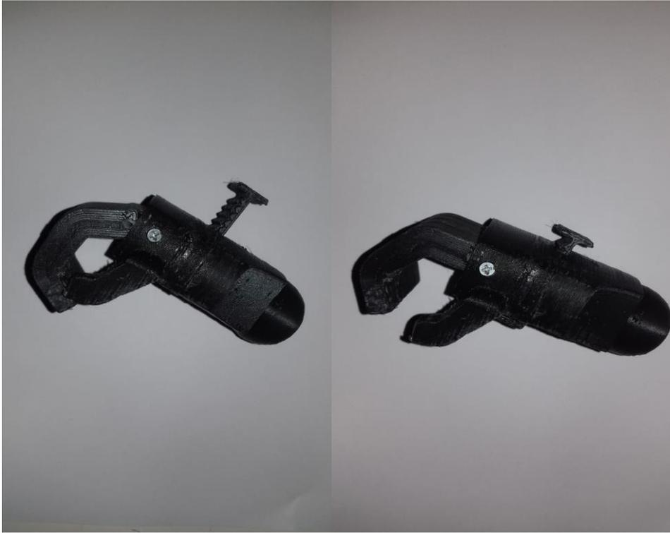
Figura 42 – Protótipo impresso do mecanismo de pegada.
