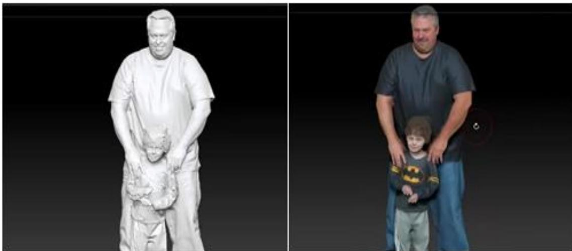
Figura 11 – Exemplo de um escaneamento feito por um Kinect 360.
