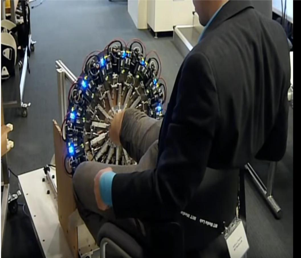
Figura 5 – Máquina de acionamento por pressão, usada para diferenciar densidade dos tecidos do membro que é inserido.
