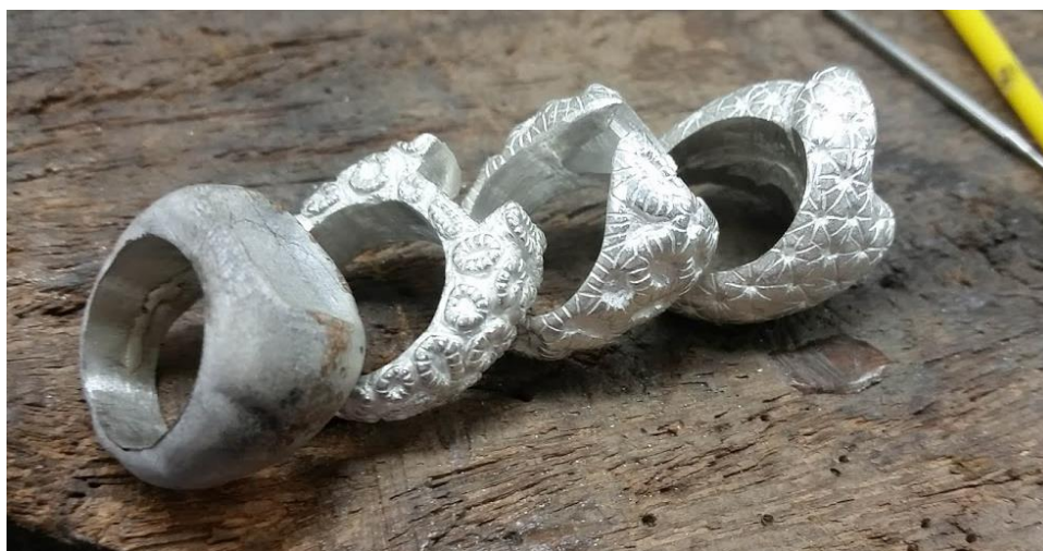
Figura 45: Anéis após a fundição.
