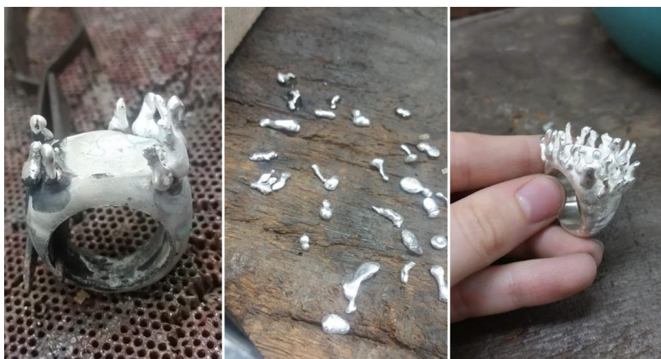
Figura 46: Processo de soldagem das garras do Anel 1.
