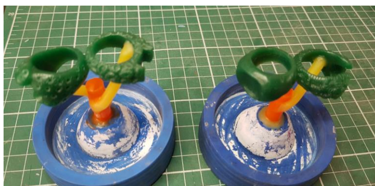
Figura 44: Montagem da árvore de fundição. Fonte: da autora
