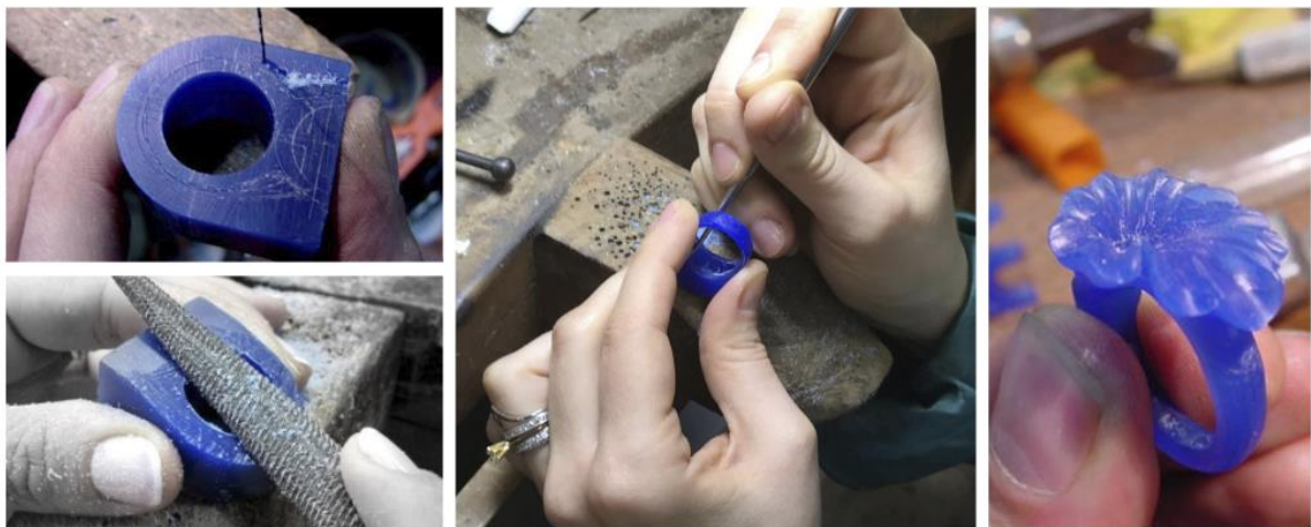
Figura 27: Algumas das etapas da fabricação de anéis por modelagem em cera Fonte: Internet
