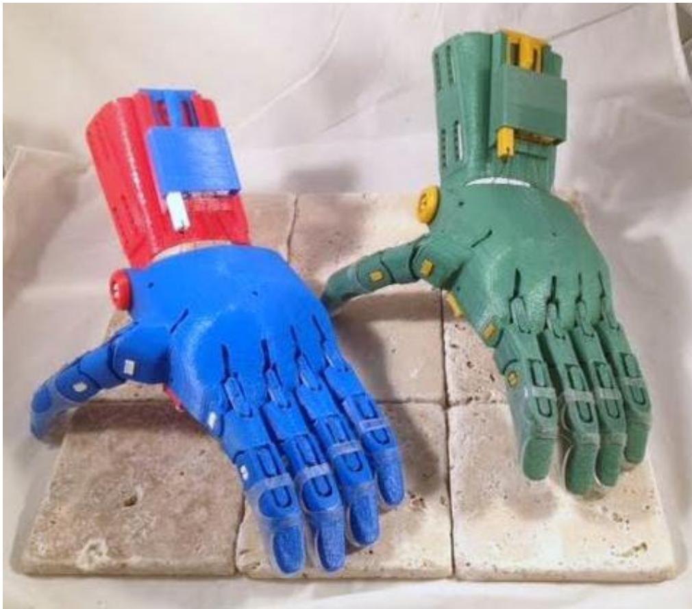
Figura 5: Phoenix Hand : modelo similar de prótese com articulação ativada manualmente. Fonte: https://enablingthefuture.org/
