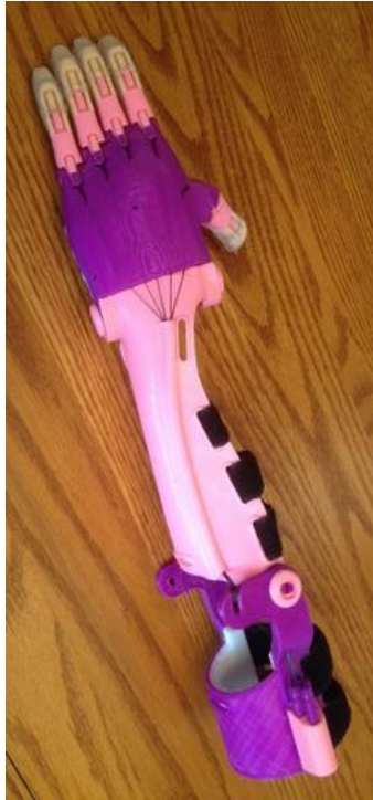
Figura 6: UnLimbited Arm. Modelo similar de prótese com articulação ativada manualmente. Fonte: https://enablingthefuture.org/
