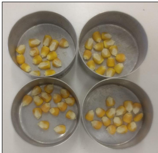
Figura 5: Amostras em recipientes metálicos prontas para serem levadas para a estufa a 105 °C.
