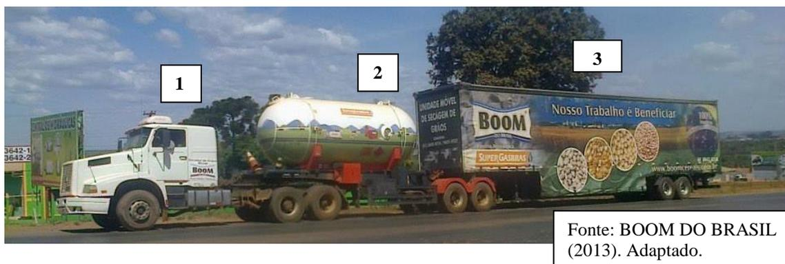
A figura 2 mostra uma das máquinas que realizam a secagem móvel. O cavalo mecânico é o único que possui força motriz neste conjunto mostrado acima, ele tem como principal função locomover o equipamento de secagem para onde for necessário, na figura um ele está identificado com o número 1. O tanque de gás está identificado na figura dois com o número 2, ele tem como função armazenar de forma segura e perspicaz o gás GLP, que será o material usado para combustão no secador.
