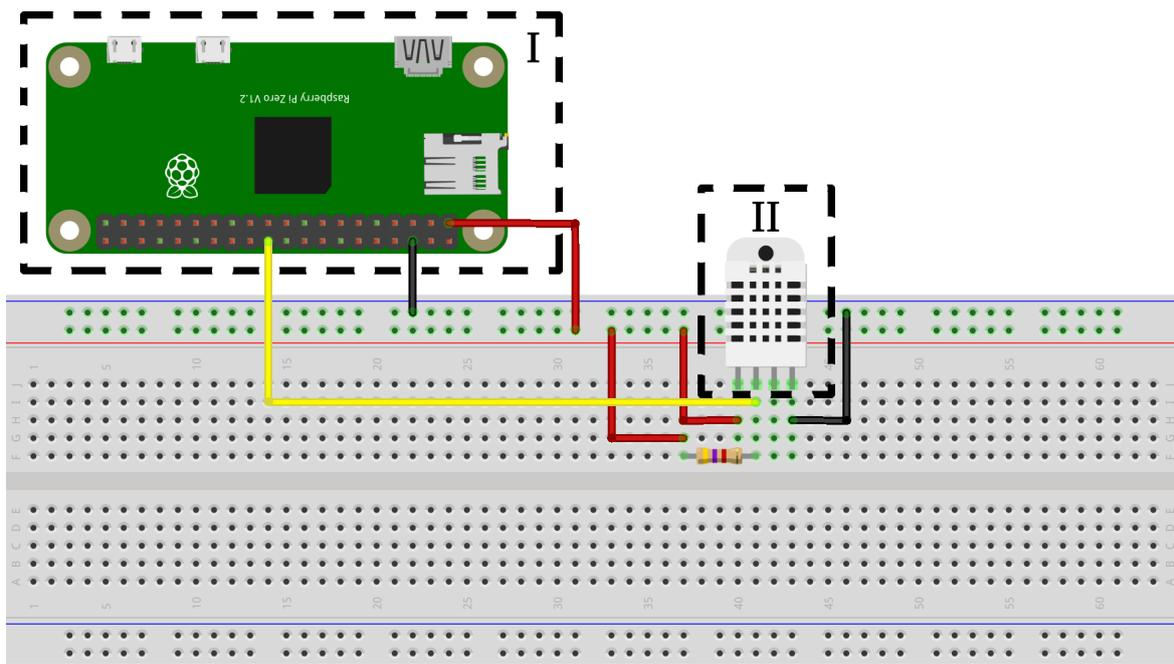
Figura 4.10: Esquema de montagem para os dispositivos sensíveis.
