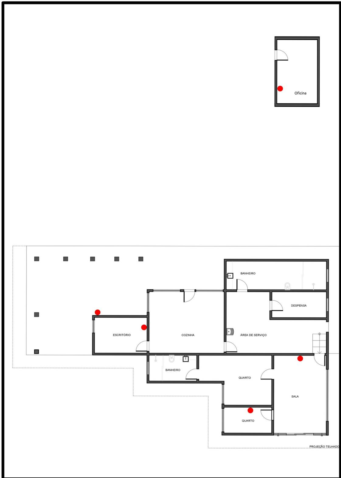
Figura 4.15: Planta baixa do ambiente escolhido para teste em escala reduzida. Os pontos em que os sensores foram instalados estão indicados em vermelho.
