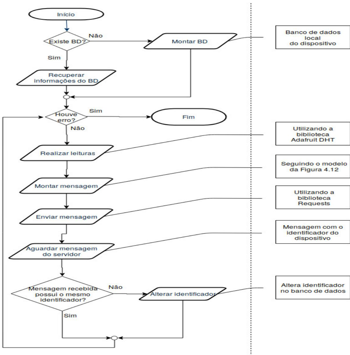
Figura 4.11: Fluxograma do funcionamento básico de um dispositivo sensível construído.
