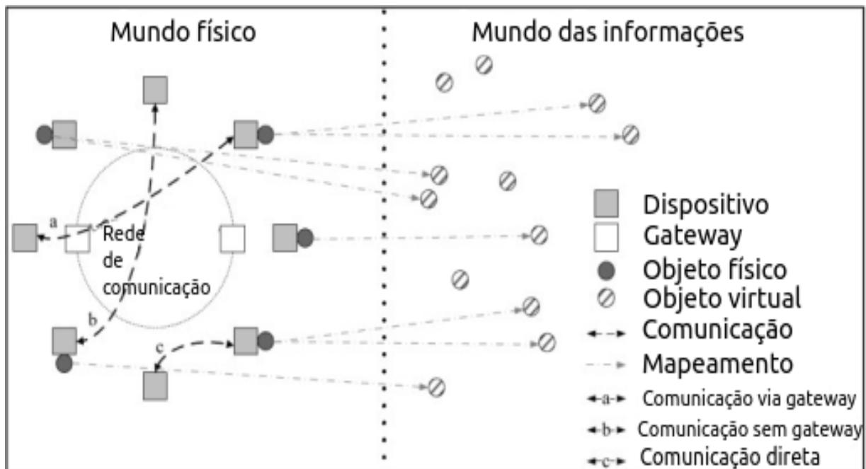
Figura 2.3: Visão geral técnica de IoT (adaptado de [8]).
