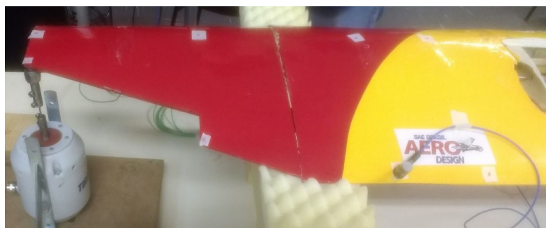
Figura 51 – Foto tirada no ensaio, com excitação pelo shaker no ponto 1, acelerômetro no ponto 16 e marcações de outros pontos de coleta de dado.
