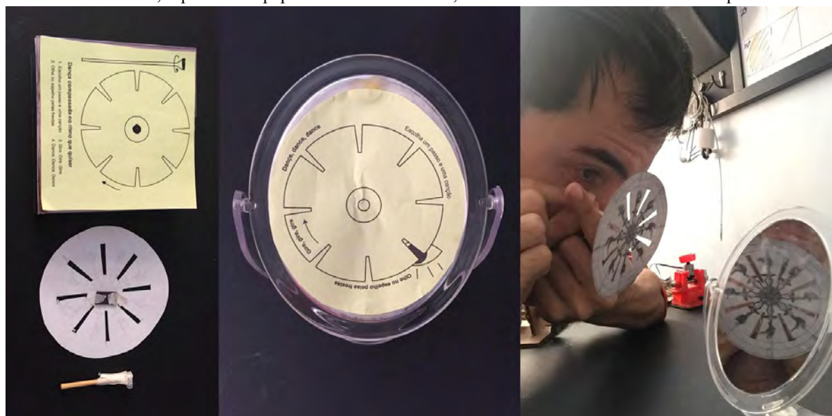
Figura 31: À esquerda, caixa com papel instrutivo, verso disco com imã e cabo de madeira com imã na ponta. No centro, espelho com papel instrutivo. À direita, teste do mecanismo do fenacístoscópio.
