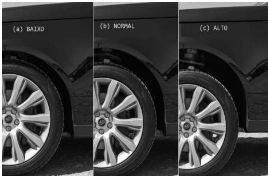
Figura 2. Configurações em suspensão a ar numa Land Rover modelo Range Rover ano 2013, equipada com o sistema de suspensão ativa a ar. Fonte: CNET, com alterações.
