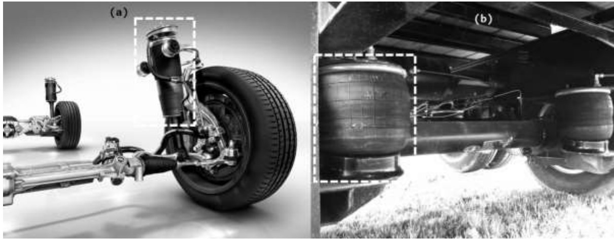
Figura 9. Diversas aplicações de suspensões a ar. Atuadores a ar instalados em (a) Audi A8 2017 e (b) em conjunto não independente de suspensão em um caminhão. Fonte: Audi e Firestone IP, com alterações.
