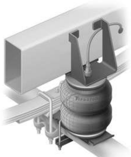
Figura 1. Sistema suspensão a ar montada em conjunto com feixe de molas em um caminhão. Fonte: Firestone IP, com alterações.
