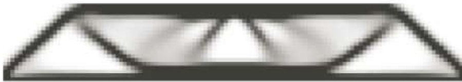
Figura 17. Resultado de um processo de otimização topológico em que foi permitido o relaxamento do problema contínuo, e elementos podem assumir densidade diferente de 1 ou 0 (representados por cores diferentes de preto). Fonte: (Padoim, 2014).
