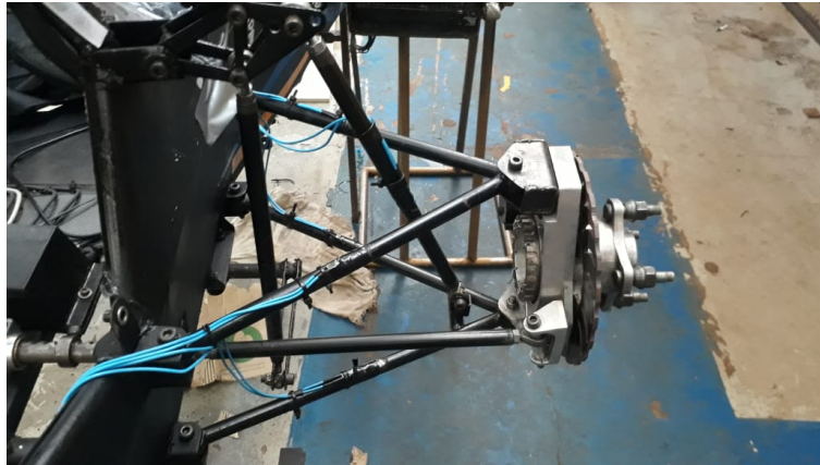
Figura 23 – Foto após finalizada a instalação do lado esquerdo do eixo dianteiro
