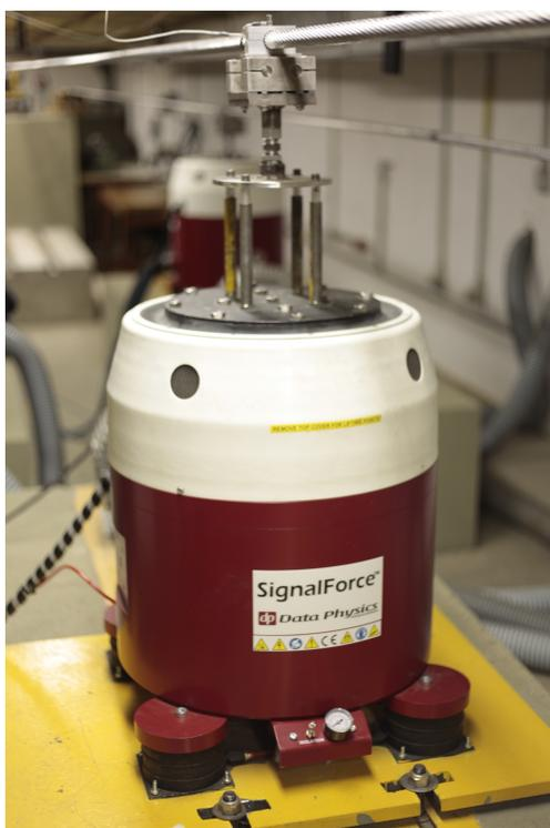
Figura 44 – *Shaker* eletromecânico.
