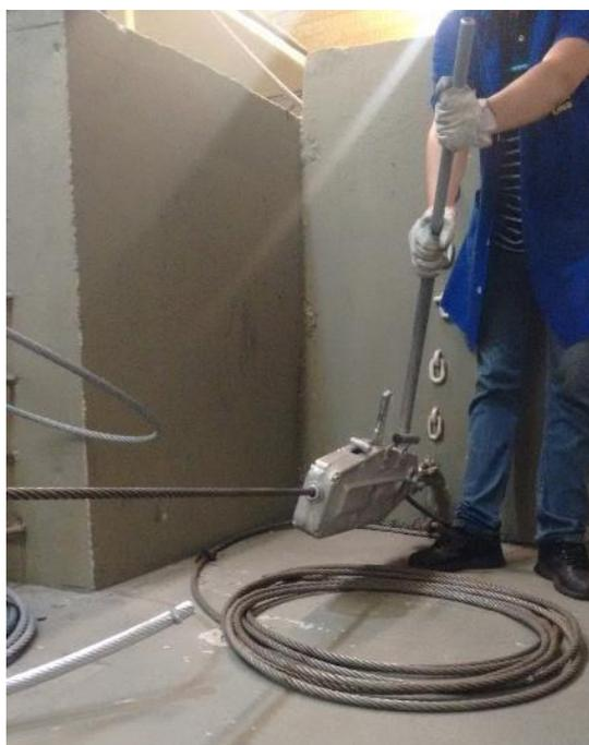
Figura 48 – Aplicação de pré carga usando tífor (ROCHA, 2006).
