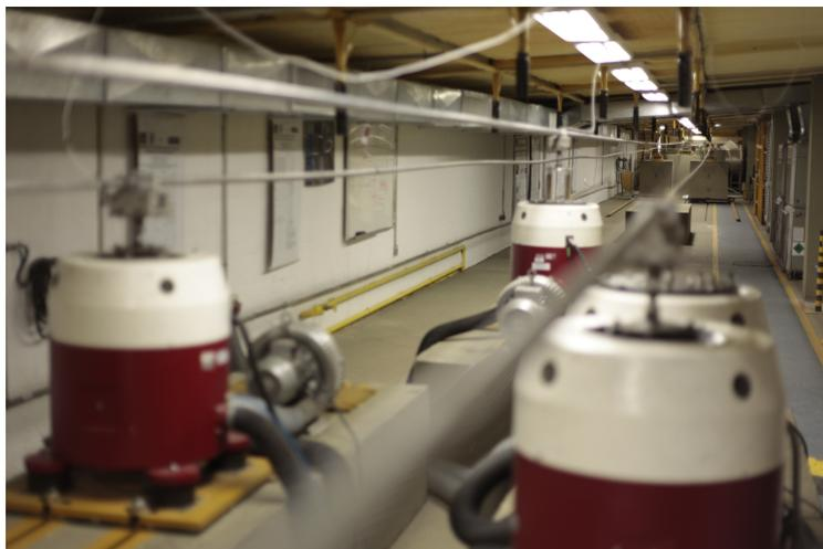
Figura 3 – Bancada para ensaio de cabos (cortesia do Laboratório de Fadiga e Integridade Estrutural de Cabos Condutores de Energia - Faculdade de Tecnologia - Departamento de Engenharia Mecânica - Universidade de Brasília).
