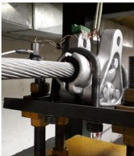
Figura 47 – Grampo CGS montado à bancada.
