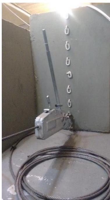
Figura 40 – Talha de alavanca ancorada ao bloco fixo (ROCHA, 2006).
