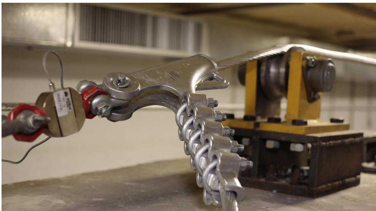
Figura 42 – Da esquerda para a direita: célula de carga, grampo de ancoragem e polia de apoio.
