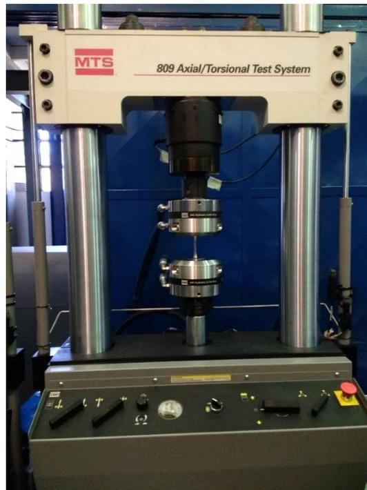
**Figura 3.1: Máquinas servo-hidráulica série 646 Hydraulic Collet Grip, Model - 809 Axial/Torsional Test System.**
