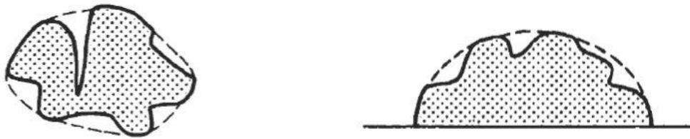
**Figura 2.19: Trincas com formato irregular e método para estimar a área efetiva (Murakami, 2002)**
