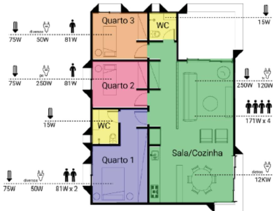
Figura 3.7 – Carga interna da casa (Sudbrack, 2017).
