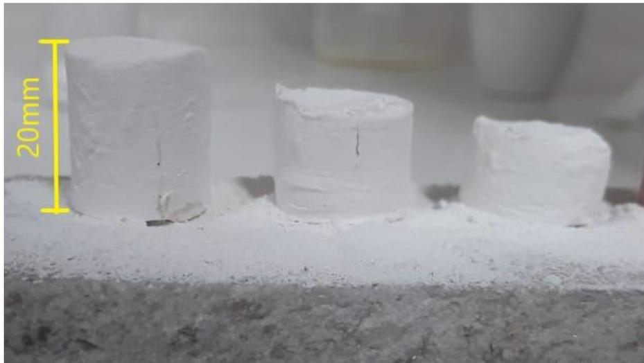
Figura 19. Três amostras de 85%  $Al_2O_3-\gamma$  / 15% MgO.
