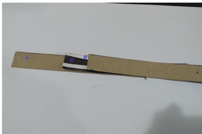
Figura 22 – Camadas do sensor: (A) papel cartão, (B) fita de cobre e (C) folha resistiva. Fonte: Autor.
