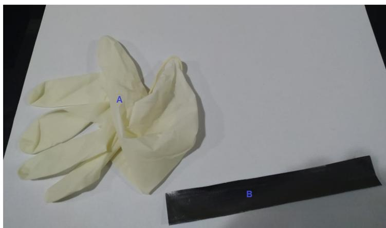
Figura 37 – Materiais com o sensor flexível de látex: (A) material látex e (B) folha resistiva. Fonte: Autor.
