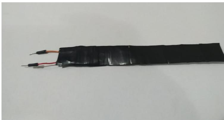
Figura 23 – Sensor flexível resistivo confeccionado, nas quais as extremidades apresentam resistência em função da flexão. Fonte: Autor.
