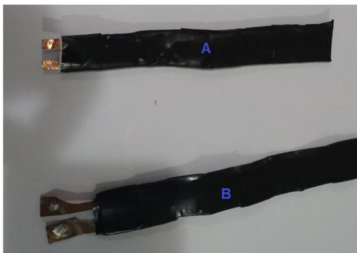
Figura 39 – Teste da fita de cobre: (A) Sensor que contém fita com a espessura de 0,074 milímetros e (B) Sensor que contém fita com a espessura de 0,500 milímetros . Fonte: Autor.
