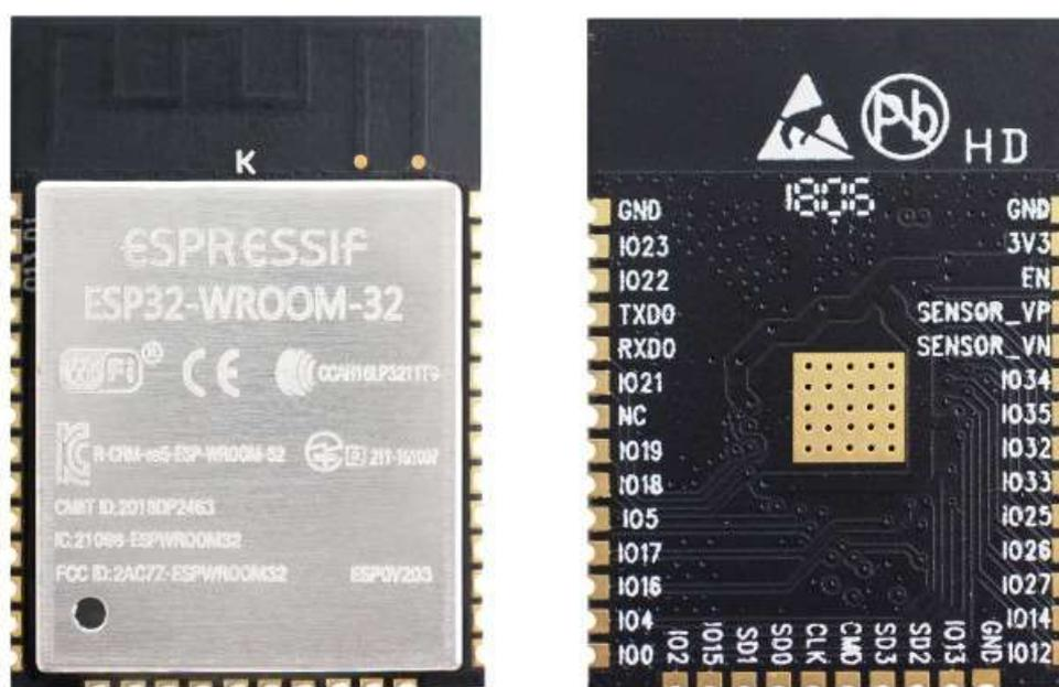
Figura 3 – Chip que contém o microcontrolador *ESP32-WROOM-32*, portas de entrada, saída, memória e entre outros periféricos. A esquerda encontra-se a vista superior do chip e a direita a vista inferior com a sua pinagem. Fonte: (ESPRESSIF, 2019).
