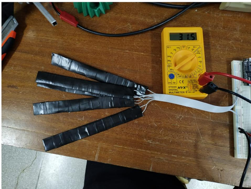
Figura 25 – Mensuração do sensor resistivo flexível com auxílio do multímetro.
