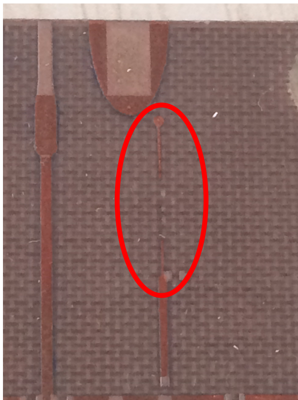
Figura 47 – Fotografia do circuito chaveador com detalhe em vermelho falha na trilha de microfita que polariza o canal direito. Fonte: Elaboração própria.
