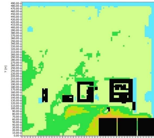
Figura 17 - Temperatura do ar em modelo de simulação real x modelo de simulação com intervenção proposta para o horário de 12h.
