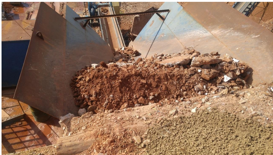
Figura 4.2 - Entrada do resíduo triado, após secagem, na Usina de Reciclagem.
