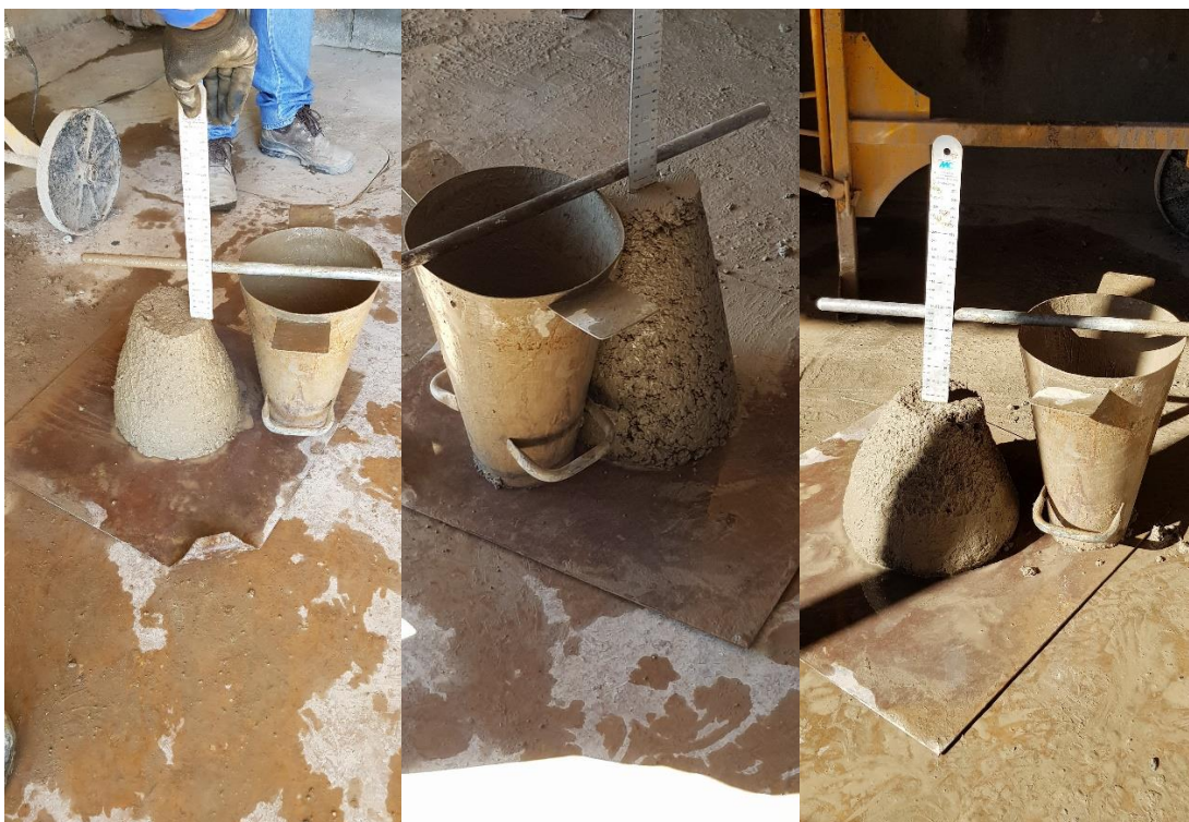
Figura 4. 1 – Execução do ensaio de abatimento.
