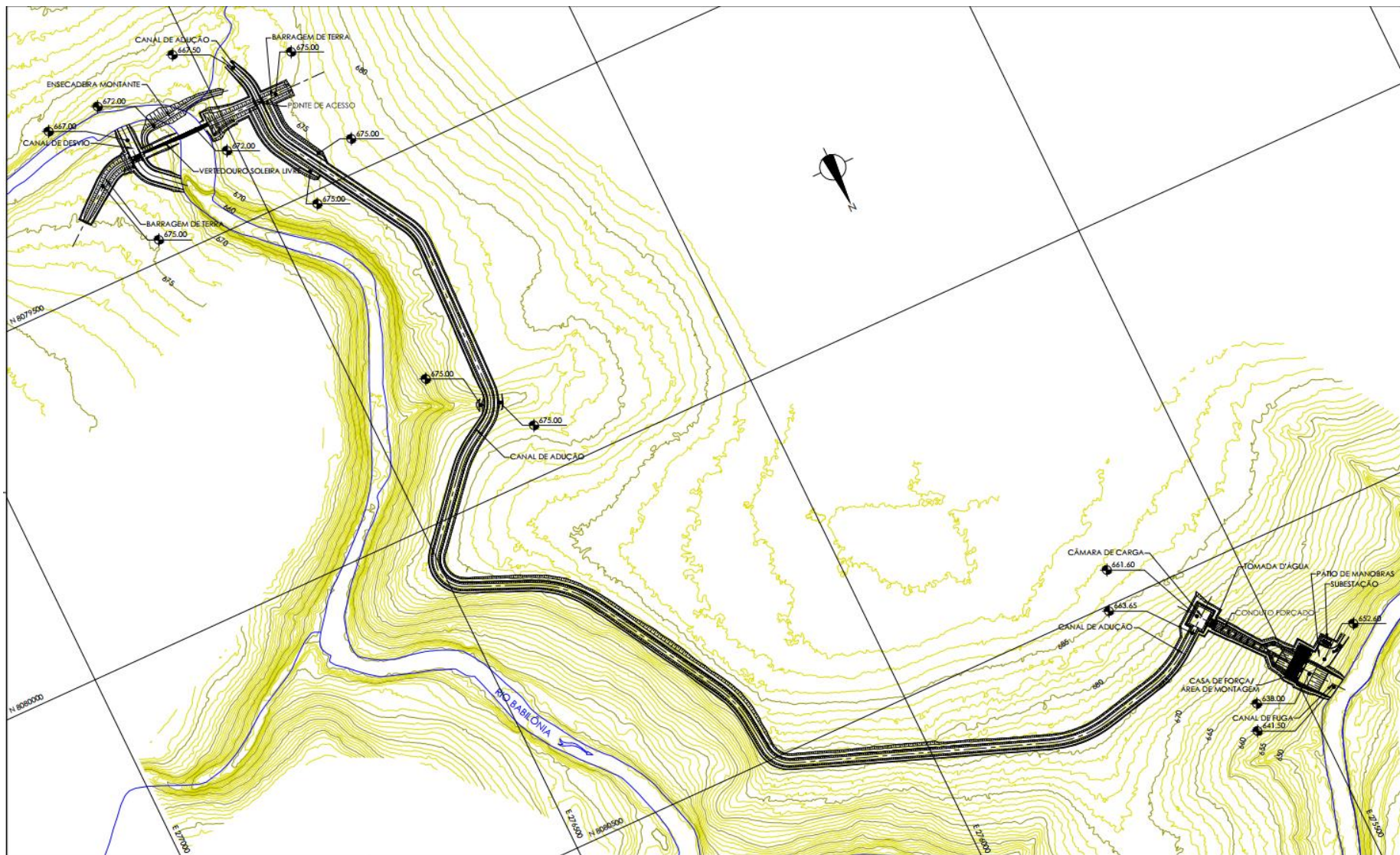
Figura 4-1: Arranjo geral da PCH Urtiga
