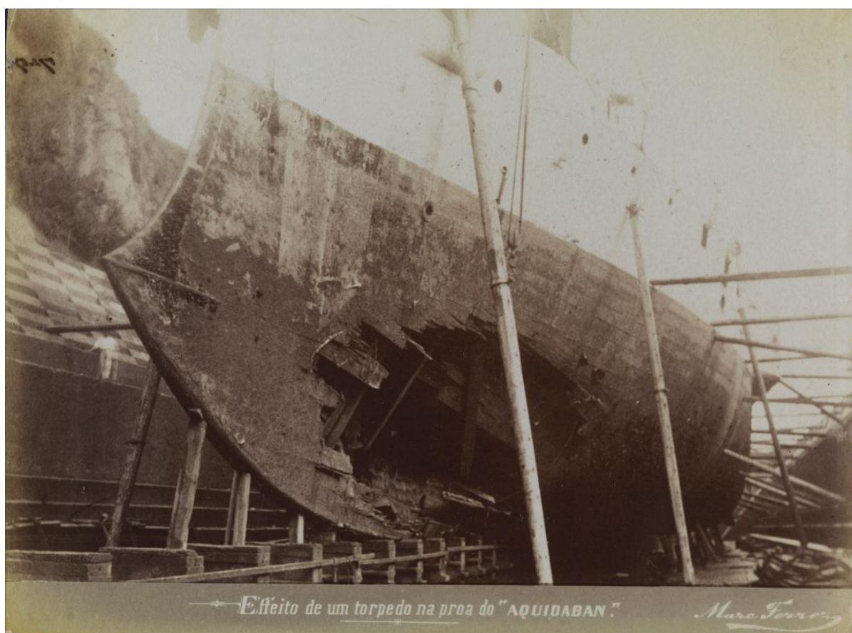
Figura 10 - Encouraçado Aquidabã com rombo no casco Fonte: Brasileira fotográfica
