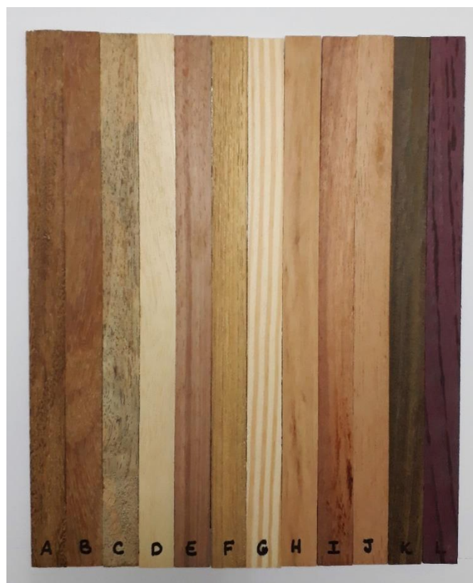
Figura 1 – Amostras das espécies estudadas. Onde A: Fava ( Vataireopsis sp. ); B: Cumaru ( Dipteryx sp. ); C: Sumaúma ( Ceiba petandra ); D: Marupá ( Simarouba amara ); E: Jequitibá ( Cariniana sp. ); F: Freijó ( Cordia goeldiana ); G: Pinus ( Pinus sp. ); H: Currupixá ( Micropholis sp. ); I: Timborana ( Enterolobium schomburgkii ); J: Cedro ( Cedrela odorata ); K: Ipê ( Handroathus sp. ); L: Roxinho ( Peltogyne sp. ).
