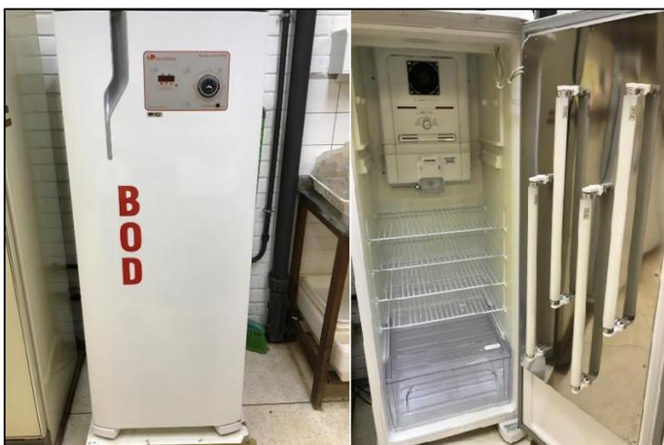
**Figura 7** – Câmara de germinação B.O.D com fotoperíodo e controle de umidade MOD. LUCA-161/04. **Fonte:** autoral.
