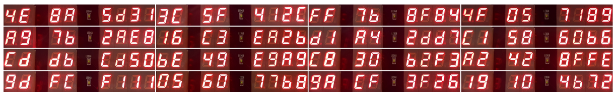
Figura 5.6: Resultado do SHA-512 de "RISC-V" na FPGA.
