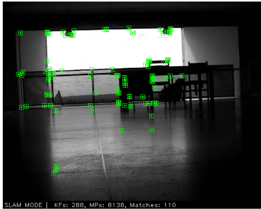
Figura 5.38: Imagem escura devido a visão para fora do prédio, operação 23/05-09:19 . Fonte: Autor.
