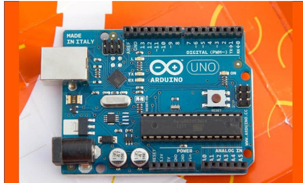
Figura 3.6: Arduino UNO (Fonte: [38]).
