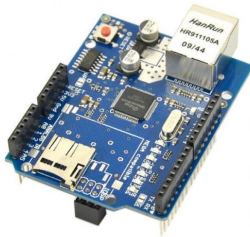
Figura 3.8: Shield Ethernet W5100 (Fonte: [39]).
