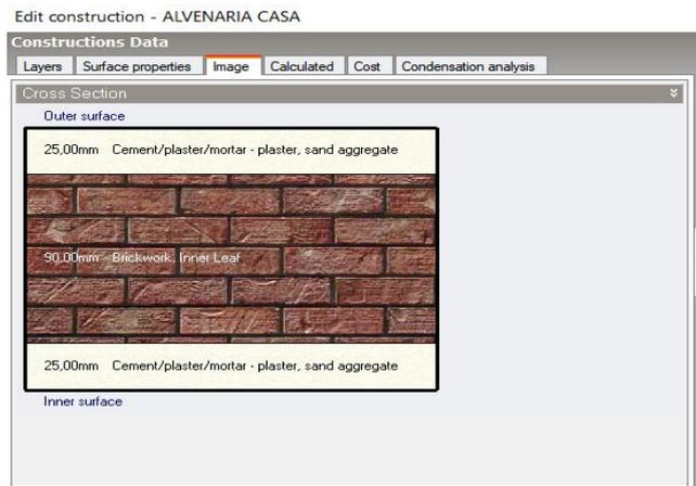
Figura 34 - Configuração de paredes em alvenaria da habitação.
