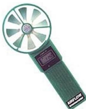
Figura 9- Anemômetro de palhetas giratórias. NEI(2018).
