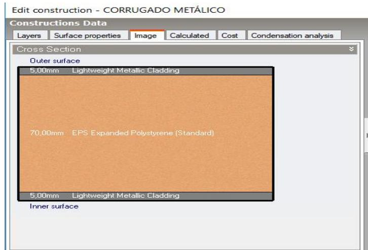
Figura 29 - Configuração de paredes metálicas do Pavilhão João Calmon.
