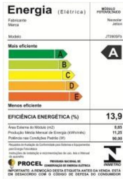
Figura 2- Etiqueta de cores PROCEL/INMETRO. DUSOLENGENHARIA (2018)
