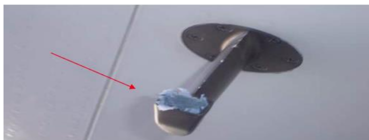
Figura 24: Sensor de temperatura do ar obstruído por plástico. Fonte: CENIPA.
