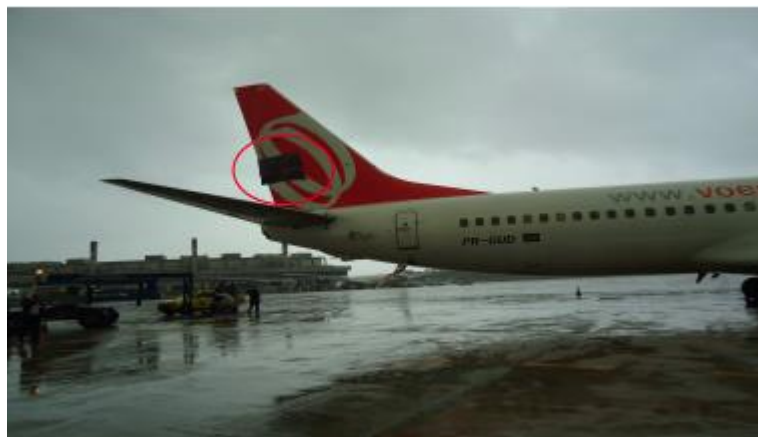
Figura 41: Danos no estabilizador vertical do Boeing 737 da Gol. Fonte: CENIPA.
